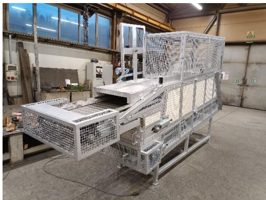
Sanacija obstoječega in izdelava novega ohlajevalnega traku
