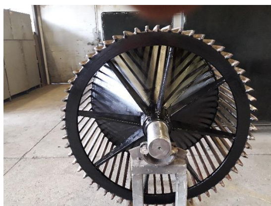
Sanacija paličasti boben fi 800x1160 - potem
