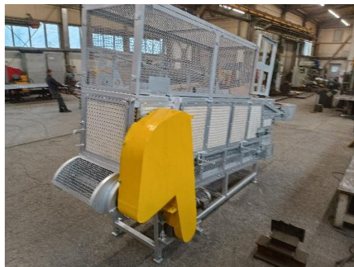
Sanacija obstoječega in izdelava novega ohlajevalnega traku
