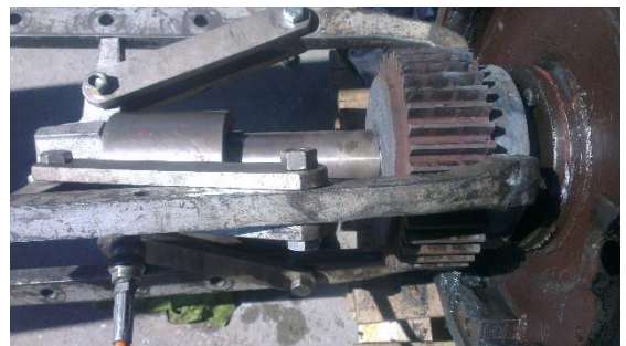
Izdelava in montaža pogonske gredi bobnastih vitlov
